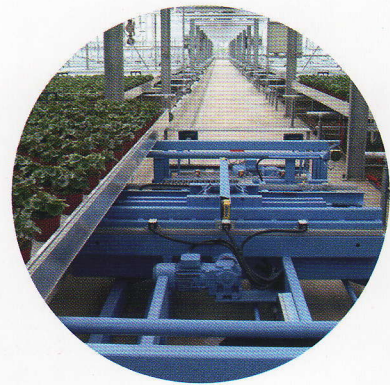
Automatischer Ein-, bzw. Mehrlagentransportroboter für die Beschickung und Entnahme von Containern
