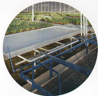
Schiengeführter, manueller Transportwagen mit Verriegelungssystem
